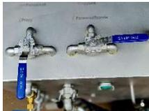
Stelle den linken Dreivegehahn auf der Oberseite des Gerätes („Druckseite“) auf „Propy“ und den rechten Hahn („Saugseite“) auf „Propytank“.
