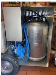
Im Inneren ist ein Aludrucklufttank als Energiespeicher und ein Propylenglykoltank verbaut.
